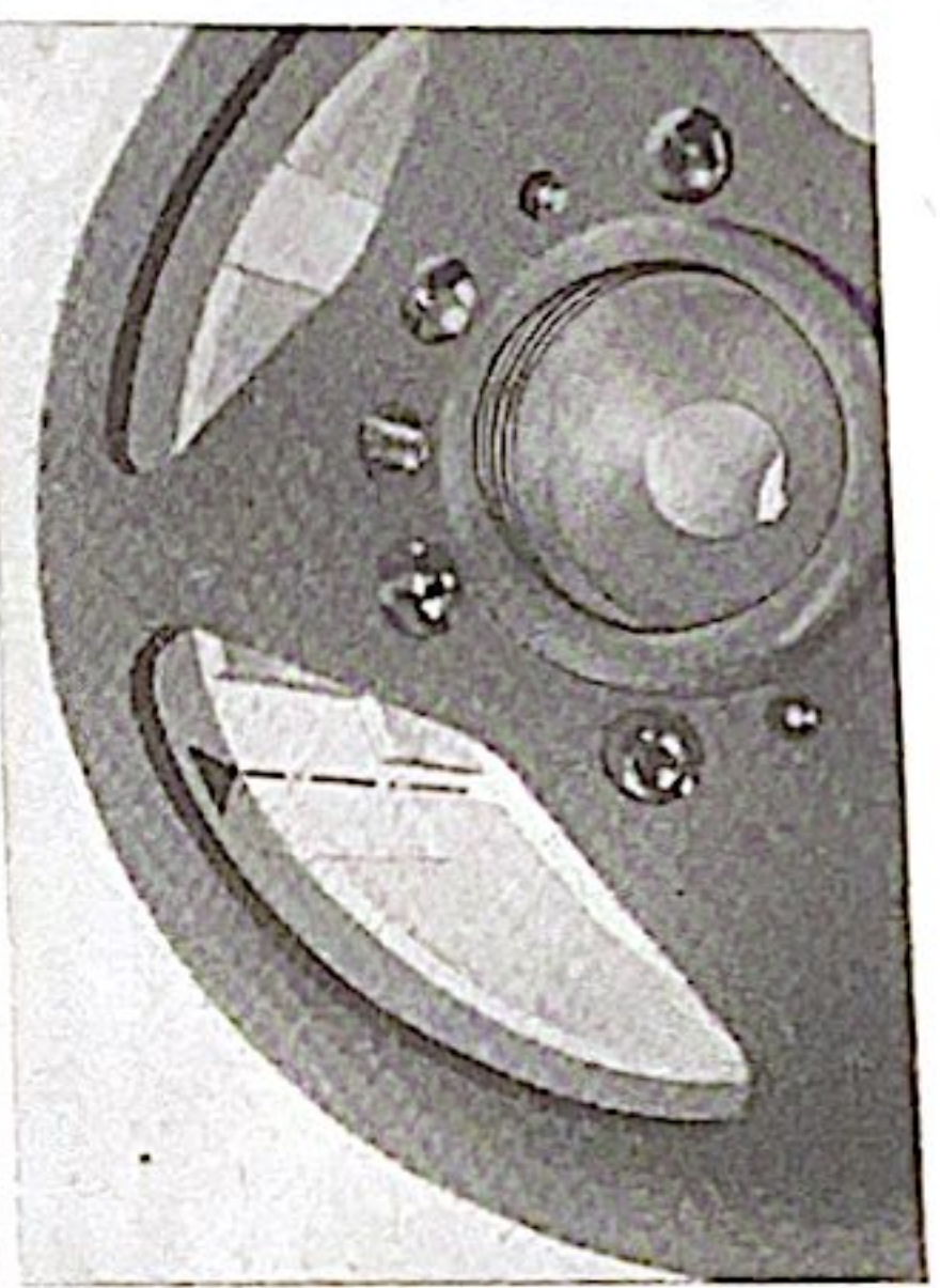
Bild 128. Mittenabstand der Steuerpolbleche in der Schwungscheibe auf deren Gehäuse bzw. der von außen sichtbaren Pappeinlage markieren
